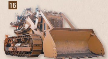
16 D50-S8 ドーザーシヨベル1号機 (昭和33年) 当時制作された試作機。バケットローダーの掘削力不足の問題点を解消するために開発されました。
