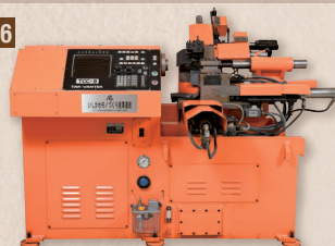
CRT付対話型 CNC旋盤 TCC-8 (昭和51年) 機械と人がコミュニケーションできる、国内初のマイクロコンピュータ搭載のCNC (コンピュータ数値制御) 旋盤。
