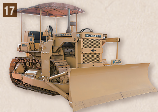
17 D50A ブルドーザ実験車 (昭和36年) 海外資本の自由化対策に対応するため、性能・耐久性の画期的向上を追求した実験車です。
