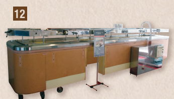
12 給湯給茶装置付寿司コンベア機 (昭和63年) 給茶装置をコンベアレーン上部に設置し、上部から給湯。省力化に貢献しました。
