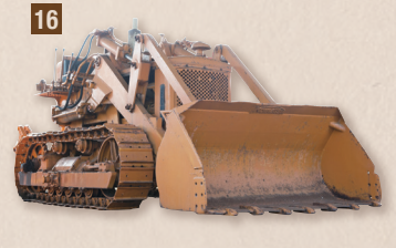
16 D50-S8 ドーザーシヨベル1号機 (昭和33年) 当時制作された試作機。バケットローダーの掘削力不足の問題点を解消するために開発されました。
