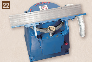
22 面取研削機 (昭和38年) 全国初の砥石を利用した面取研削機。刃物では割れない焼入れしたものも加工可能です。
