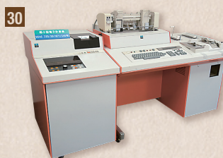
30 USAC720 (昭和48年) オフコン分野初のマイクロプログラミング方式を採用。入出力チャンネル方式により入出力同時動作が可能です。
