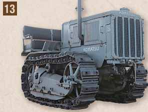
13 T25 トラクタ (昭和11年) 旧小松工場で製造された現存する世界最古のトラクター。昭和7年から18年までに238台生産されました。
